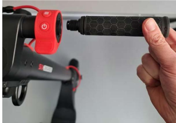
Die Griffe sind mittels eines Gewindes im Lenkerkopf festgeschraubt. Die Gewinde des linken und rechten Griffs sind **gegenläufig**.
